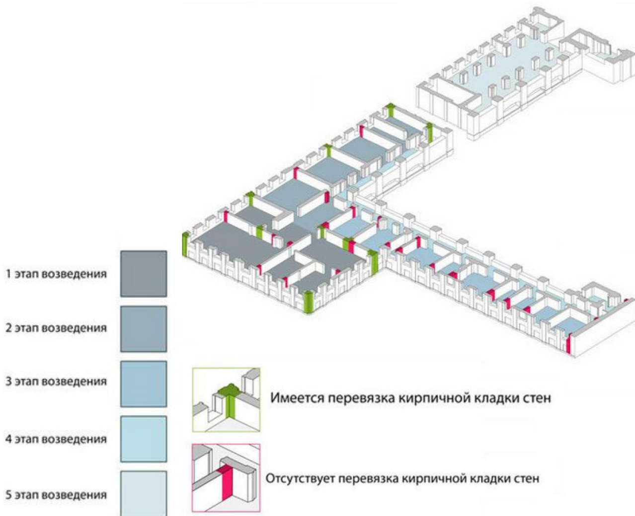
Рис. 1. Схема этапов строительства западного крыла дворца Меншикова с обозначением типов перевязки кирпичной кладки
