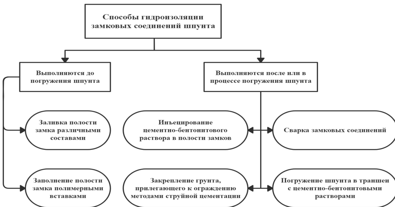
Рис. 1. Способы гидроизоляции замковых соединений шпунта
