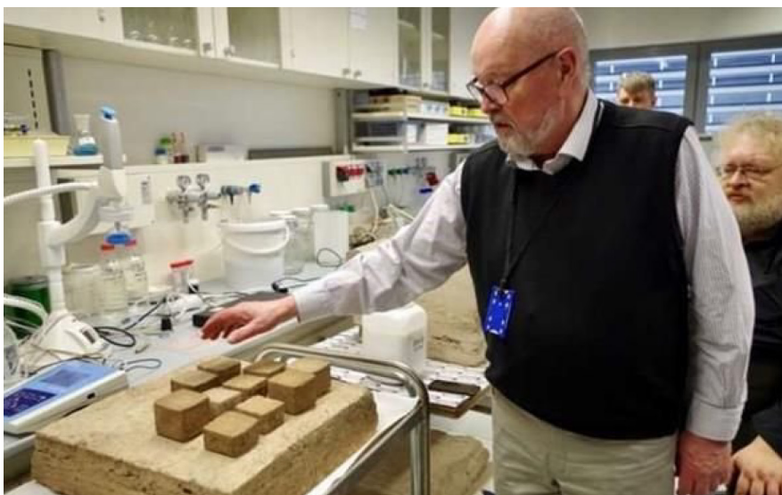
Рис. 1. Тестовые образцы, напечатанные на 3D-принтере с применением торфа, сланцевой золы и наночастиц кремния
